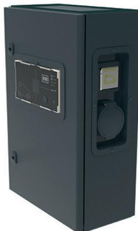
**BORNE 1 VE MONO GREEN'UP PREMIUM DÉTECTION 6 MA DC INCLUSE 3,7KW À 4,6KW MODE 2/3 MÉTAL**
