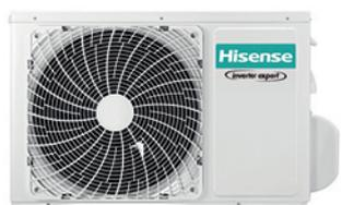
Unité extérieure monosplit 2,5 kW au fluide frigorigène R32 pour unité intérieure universelle murale New Comfort 2,5 Kw. D'une puissance calorifique de 2,8 kWatts et d'une puissance frigorifique de 2,6 kWatts, cette unité Mono-split monophasée fonctionne au gaz R32, mesure 715x482x240 mm (lxHxP) et pèse 24 kg. Les liaisons frigorifiques 1/4-3/8 nécessaires à l'installation sont disponibles en option. Niveau sonore de 63 dB(A).
