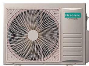
Unité extérieure multisplit 3 postes 7,2 kW au fluide frigorigène R32 pour unités intérieures murales, consoles, cassettes et gainables. D'une puissance calorifique de 8 kWatts et d'une puissance frigorifique de 7 kWatts, cette unité Multi-split monophasée fonctionne au gaz R32, mesure 860x670x310 mm (lxHxP) et pèse 49 kg. Les liaisons frigorifiques 1/4-3/8 nécessaires à l'installation sont disponibles en option. Niveau sonore de 63 dB(A).
