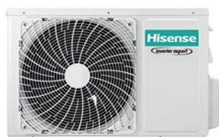
Unité extérieure monosplit 3,5 kW au fluide frigorigène R32 pour unité intérieure universelle murale New Comfort 3,5 Kw. D'une puissance calorifique de 4 kWatts et d'une puissance frigorifique de 3,5 kWatts, cette unité Mono-split monophasée fonctionne au gaz R32, mesure 715x482x240 mm (lxHxP) et pèse 25 kg. Les liaisons frigorifiques 1/4-3/8 nécessaires à l'installation sont disponibles en option. Niveau sonore de 63 dB(A).
