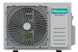
Unité extérieure multisplit 2 postes 5,2 kW au fluide frigorigène R32 pour unités intérieures murales, consoles, cassettes et gainables. D'une puissance calorifique de 5,5 kWatts et d'une puissance frigorifique de 5 kWatts, cette unité Multi-split monophasée fonctionne au gaz R32, mesure 810x580x280 mm (lxHxP) et pèse 35 kg. Les liaisons frigorifiques 1/4-3/8 nécessaires à l'installation sont disponibles en option. Niveau sonore de 60 dB(A).
