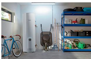
Chauffe-eau thermodynamique ÉgéO vertical sur socle livré avec raccord diélectrique tournant 3/4" et tube d'évacuation des condensats. Idéal pour 3 personnes. Il est de dimensions (HxØ) 1529x575 mm pour une puissance de 1800W et un temps de chauffe de 3h42. Équipé d'une interface tactile intuitive, il est possible de régler et visualiser la quantité d'eau chaude disponible. Il dispose d'un pilotage à distance via la connexion Wi-Fi et l'application Cozytouch.
