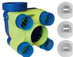
Kit VMC simple flux hygroréglable de type B, basse consommation 18,3 W-Th-C, pour logement du T3 au T7 jusqu'à 4 sanitaires, bouches à piles avec commande cuisine par interrupteur et WC par détection de présence.
