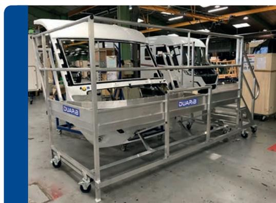
Plate-forme pour fabrication sur lignes de production
