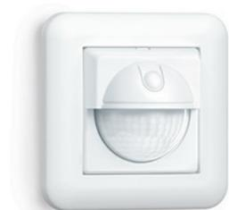
Détecteur type interrupteur IR 180 UP easy, fonctionne avec des installations bifilaires et trifilaires, remplace l'interrupteur sous crépis, équipé d'un détecteur infrarouge de 180° (portée de 8 m) et bouton pour une commutation manuelle.
