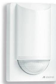
Détecteur de mouvement infrarouge IS 2180-2 pour l'extérieur, hauteur de montage jusqu'à 2m, angle de détection 180°, portée max. 12m ou 5m, seuils temporel et de crépuscularité réglables, éclairage permanent, support mural d'angle inclus.
