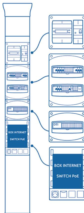
La platine d'abonné fournisseur d'énergie (pour disjoncteur général et/ou compteur électronique)
